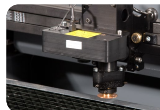
Kit CCD camera per taglio a registro/lettura marcatori
