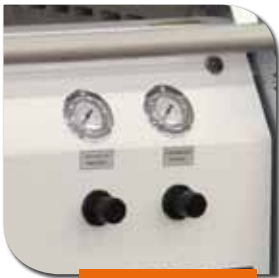
Kit per gestione gas di assistenza taglio/marcatura
