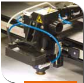
Kit CCD camera per taglio a registro/lettura marcatori
